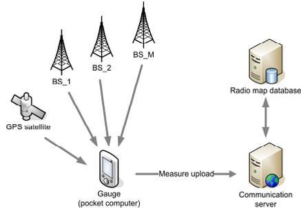
Fig. 2. Gauge subsystem.
