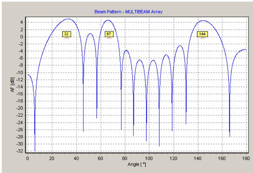
Fig. 2. Multibeam array beam pattern.
